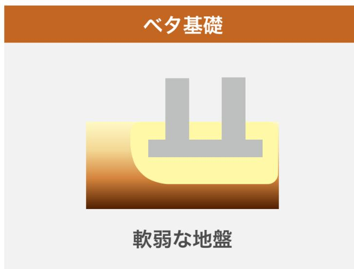
布基礎の間にコンクリートを流し込み、広い面積のコンクリートで建物を支える。軟弱な地盤向き
