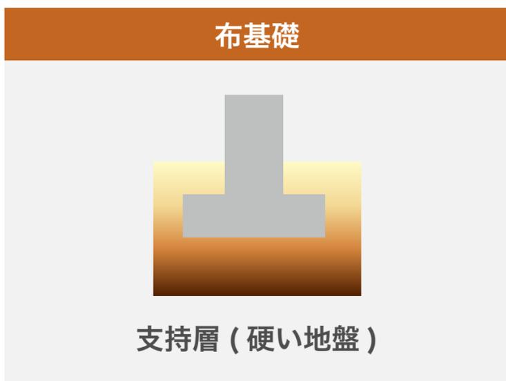
もっとも一般的な基礎工事。通常の地盤に用いられる。鉄筋コンクリート造が標準
