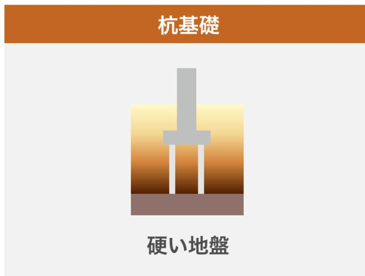
しっかりした地盤の層まで杭を打ち込み、布基礎を支える。軟弱な地盤向き
